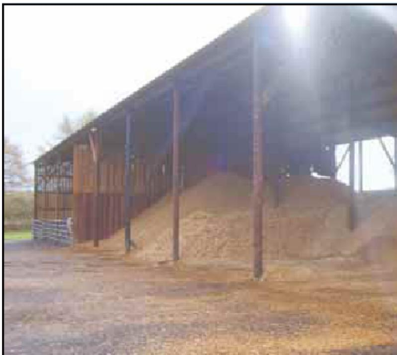
Pour pouvoir sécher naturellement, la plaquette fraîche (taux d'humidité compris entre 50 et 60%) doit être disposée **en tas, à l'abri des intempéries**. Les micro-organismes aérobies (vivant en présence d'oxygène) contenus dans le bois engagent alors **une fermentation naturelle**. Celle-ci provoque une **élévation de la température du tas** (le cœur du stock peut atteindre 70°C) qui permet un **assèchement progressif** des plaquettes.
