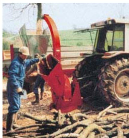
Selon le diamètre du bois à déchiqueter et le volume annuel de plaquettes à produire, on peut utiliser une déchiqueteuse à alimentation manuelle ou à alimentation par grappin.
