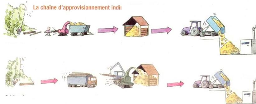
Schéma 1 : Broyage en forêt et transport de la plaquette au hangar de stockage
