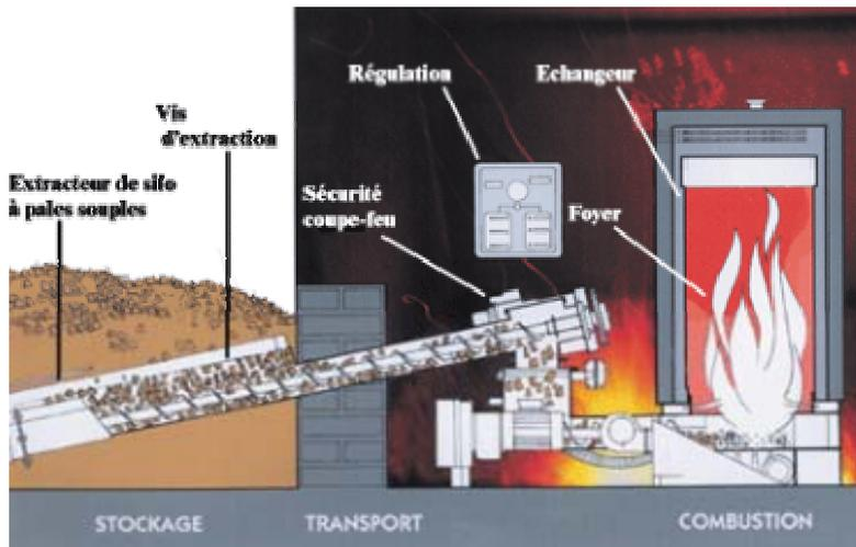
Le fonctionnement de la chaudière est entièrement **automatique**. L'allumage est réalisé par un générateur d'air chaud. La régulation commande l'arrivée du combustible en fonction des besoins de chaleur. Une vis sans fin, des tapis ou des poussoirs motorisés assurent l'alimentation de la chaudière en transportant le combustible du silo vers le foyer à combustion.
